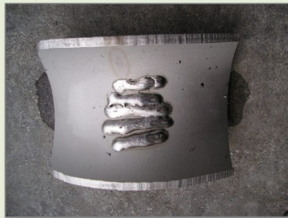
溶接焼けの除去
